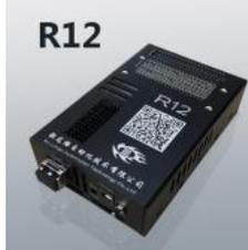
R12 支持 MIPI D-PHY, C-PHY 的单摄图像测试板, 最多可以测试 4lane MIPI D-PHY, 3Trio C-PHY, 支持 D-PHY 每 lane 1.5G, C-PHY 每 Trio 2.0GSps, 支持 DDR4 高速缓存, 低功耗电源供给设计。
